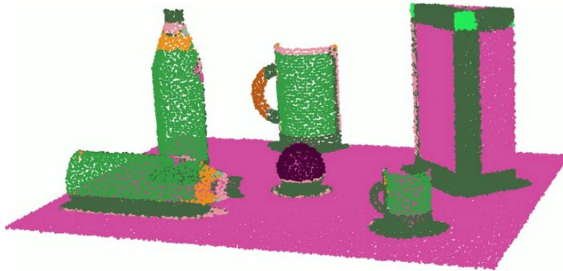
Abbildung 5.7: Mittels Normalenvektoren segmentierte Szene. [RMBB08a]
