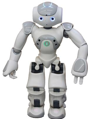
Abbildung 2.1: Humanoider Roboter NAO der Firma Aldebaran Robotics
